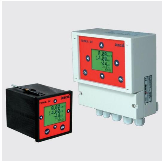
Teplotná kompenzácia merania sa vykonáva automaticky alebo manuálne. Signálne funkcie alarmu sledujú priebeh merania podľa voľne nastaviteľných minimálnych a maximálnych medzných hodnôt. Meranie voľného chlóru a oxidu chloričitého je zaisťovanie voliteľne potenciostatickým alebo amperometrickým meracím článkom.
